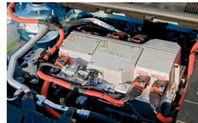
▲ De elektromotor lijkt uiterlijk sterk op een verbrandingsmotor en weegt slechts 160 kilogram.
